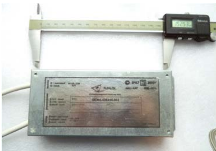
Илл.6. Блок питания (длина корпуса 152мм).
