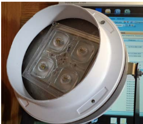
Илл.5 Модульная вторичная оптика и бленда.
